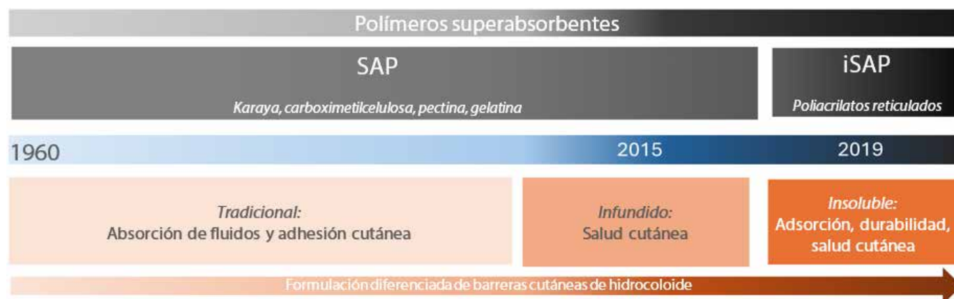
Figura 9. Evolución de la aplicación de la tecnología SAP segmentada por tipo de polímero superabsorbente y formulación cutánea de hidrocoloide.
