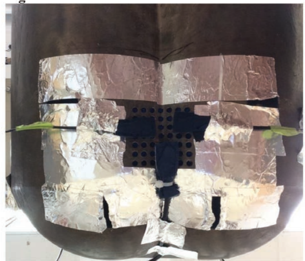
图2. 7\times 7\text{ cm} 带孔区域的压头，覆盖有镀铝胶带
