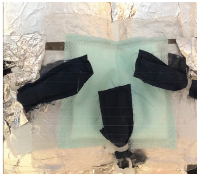
Figure 4 : positionnement du pansement et des capteurs sur les pansements
